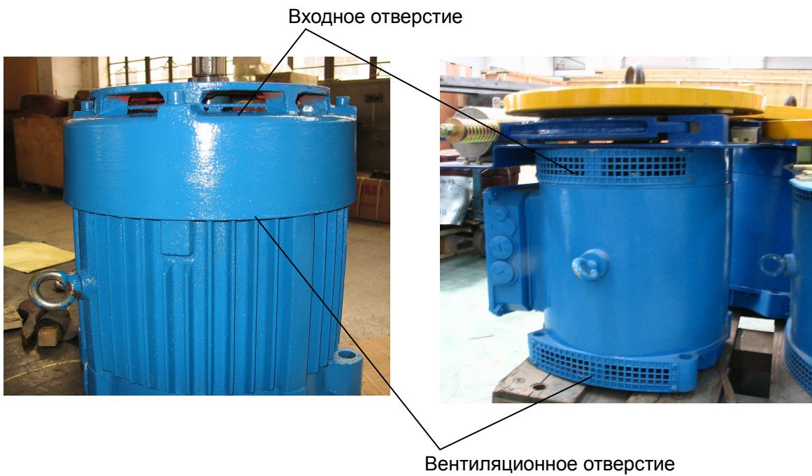
Рис. 4-21. Очистка электромотора
