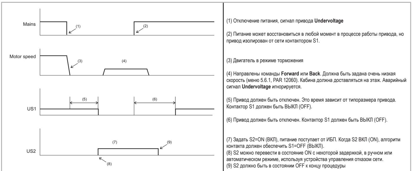
Рис. 7.3.2.6: Схема аварийных соединений (для типоразмеров ADL300-...-2M-1011 ...3055)
