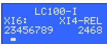
Статус выходных сигналов на плате [LC100-I](#) для коннектора XI6 и статус релейных выходов XI4. Отображение происходит только, если к системе подключена плата [LC100-I](#), заданная с помощью параметра [A-05](#).
