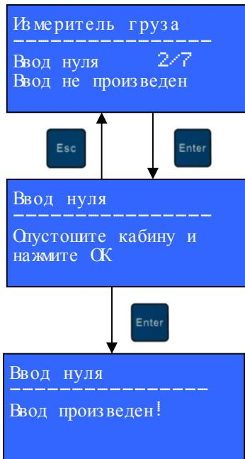
Меню ввода нуля используется для калибровки измерителя груза при пустой кабине. Если калибровка в состоянии пустой кабины еще не выполнена, то следует сообщение „Не введено“. Посредством нажатия клавиши Enter начинается процесс калибровки.
