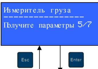
Получение параметров измерителя груза используется только в случае замены модуля LC100-K. Параметры должны быть перед этим подготовлены для модуля LC100-D посредством меню „5/7 Подготовь параметры“, после чего они могут быть перенаправлены на другой модуль LC100-K (подобно передаче параметров модуля LC100-C).
