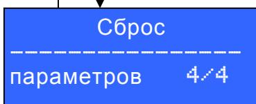
При сбросе параметров системы всем параметрам возвращаются заводские настройки. После подтверждения сброса параметров необходимо выбрать набор параметров в зависимости от конфигурации привода лифта.
