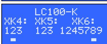
Статус входных сигналов на плате [LC100-K](#) для коннекторов XK4, XK5 и XK6. Отображение происходит только, если к системе подключена плата [LC100-K](#), заданная с помощью параметра [A-06](#).
