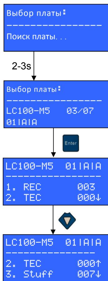
После входа в меню «Анализ ошибок», модуль LC100-D ведет на CAN-шине поиск всех подключенных модулей LC100. Для того, чтобы модули LC100 могли отправлять сообщения о состоянии своих счетчиков ошибок, их версия должна быть **firmware 4.00 или более поздняя**.
